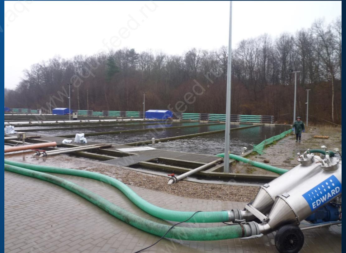
УЗВ канального типа для выращивания посадочного материала форели навеской 50 грамм мощностью 150 тонн в год (Дания)
