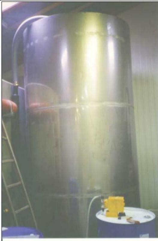
Производство ила при этом будет достаточно высоким и установку придется промывать, обычно раз в неделю. Опыт показывает, что для системы, в которую подается 200 кг корма в день достаточно емкости объемом 10 м<sup>3</sup>. Часто встречающаяся проблема – избыточная концентрация нитрита на выпуске. Рекомендуется использовать меньшие установки.
