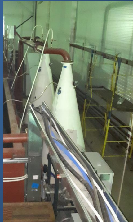
Корпус низконапорного оксигенатора Расход воды 1000 м 3 /час, насыщение 120 – 135%
