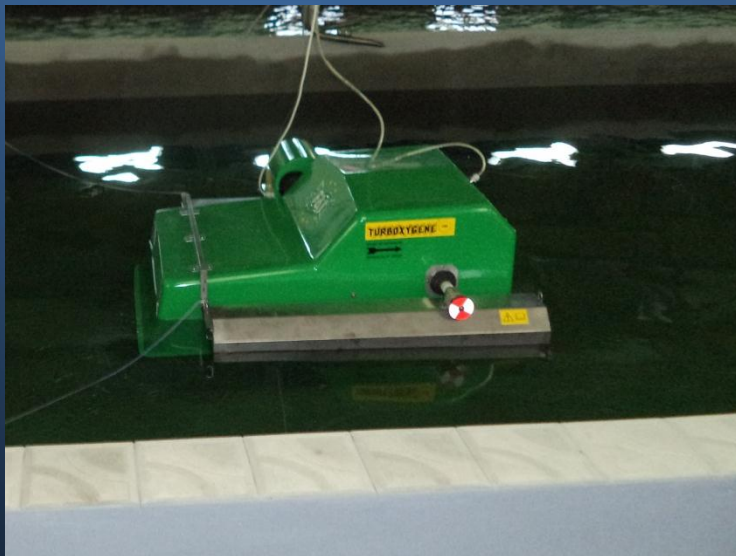
Низконапорный плавающий оксигенатор с принудительной аэрацией, 2 кг O 2 /час На бассейне 1000 м 3 - 4 устройства поднимали уровень кислорода на 5 мг/л, энергопотребление 1300 Ватт.
